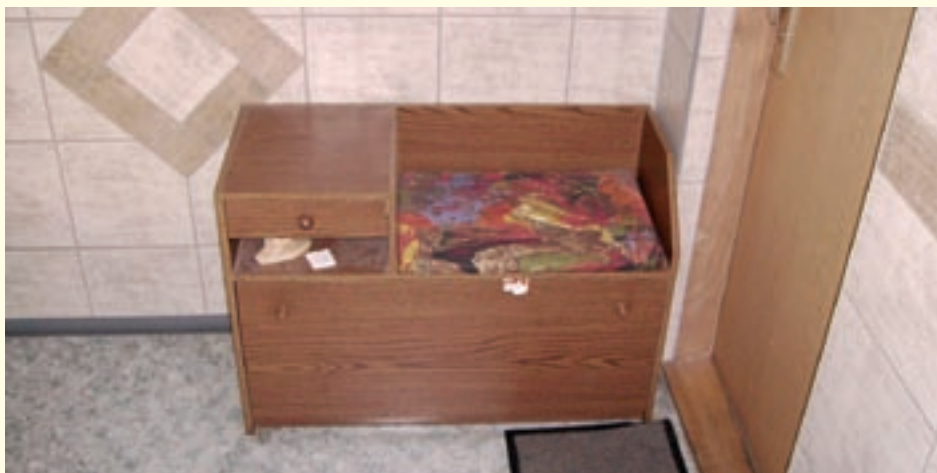
Auch wenn der Telefonschrank jetzt der Schuh Aufbewahrung dient, erhöht er doch die Brandlast.
